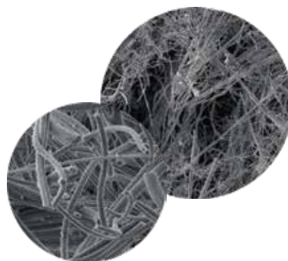
struktura \text{SiO}_2 mikrovláken zobrazeno pomocí SEM
