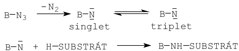
Obrázek 11-33. Princip fixace azidů na substrát vznikem nitrenu
