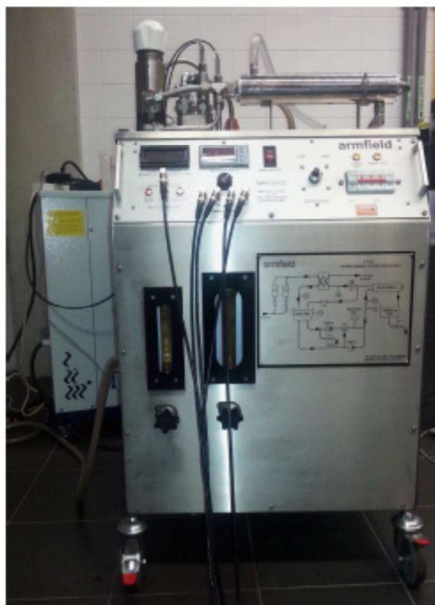
Obrázek 3 Nanofiltrační aparatura FT 18 (v pozadí chladičící zařízení TAE evo).
