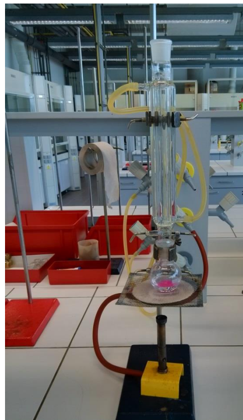
Obrázek 3: Aparatura pro zahřívání v organickém rozpouštědle – skutečná aparatura.
